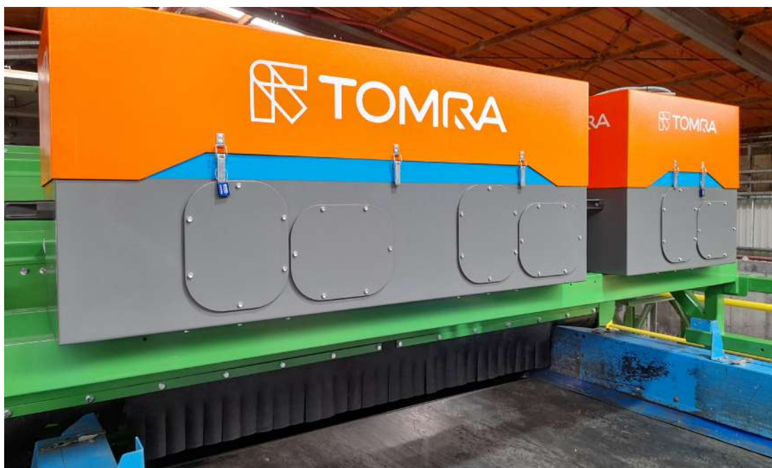
Figura 13. Novo equipamento de separação ótica instalado
