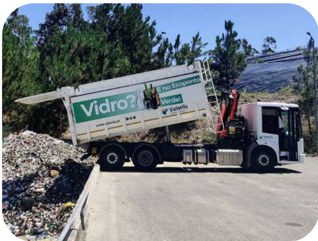
Figura 13. Descarga de vidro
