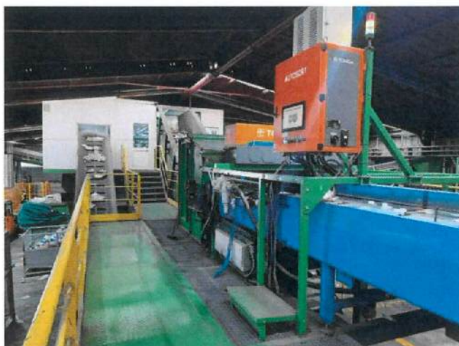
Figura 14 – Separador ótico na Unidade de Triagem
