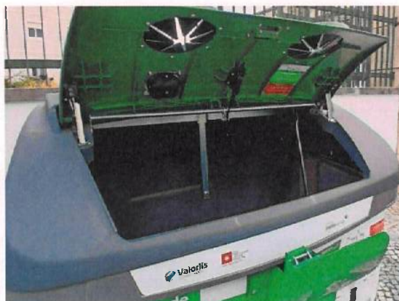
Figura 4 - Contentor de grande capacidade equipado com sensor de enchimento e baldeamento assistido
