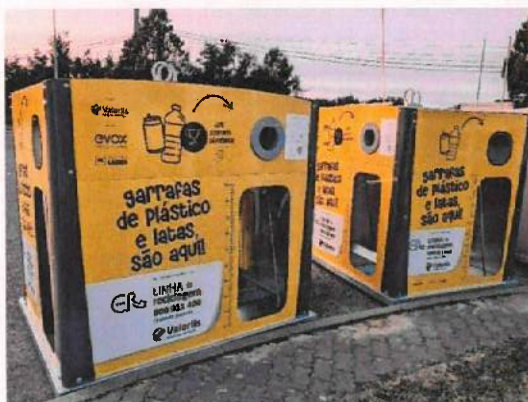
Figura 25 – Contentores protótipo com identificador RFID e leitor de embalagens
