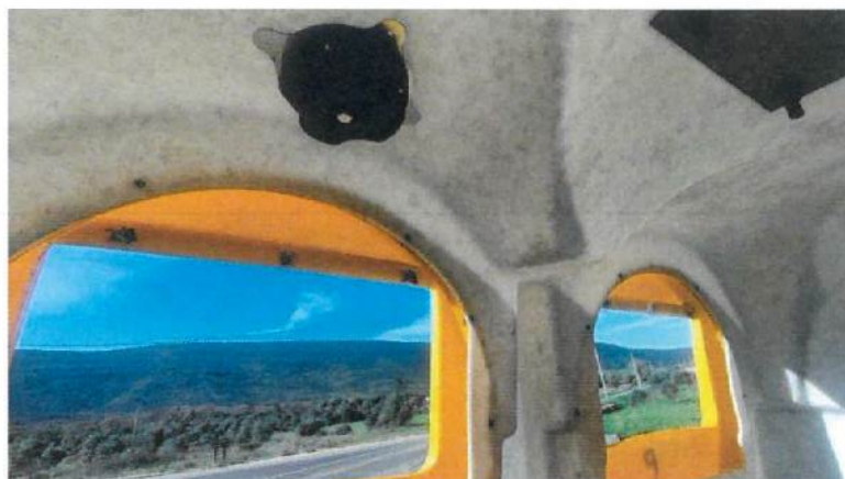
Figura 7 – Contentor equipado com sensor de enchimento
